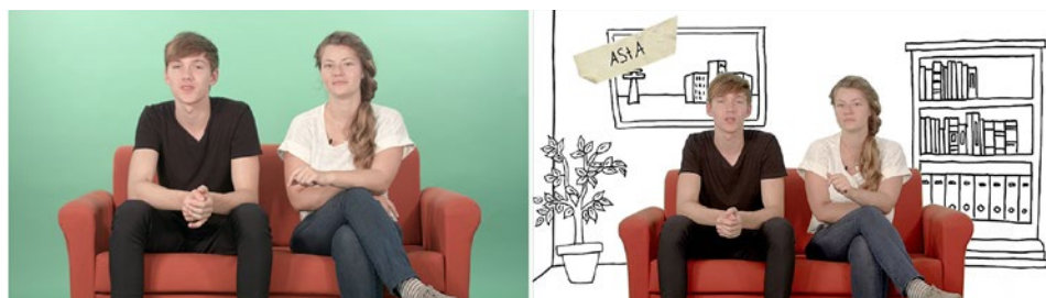
Abbildung 22: Greenscreen-Aufnahme (links) und Grafik im Hintergrund durch Austausch der Schlüssel­farbe (rechts) (Quelle: Heinecke, UHH)
